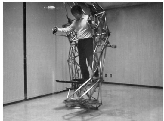
歩行燃費検討用の無動力人間搭乗型巨大二足歩行ロボットの搭乗風景
