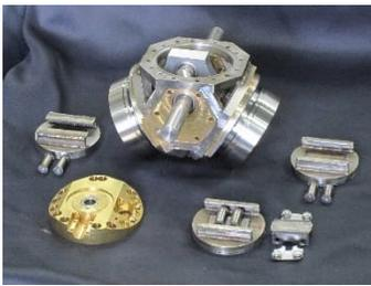
図5 ベース・ラジアル機構エンジンの第2試作機(製作中)
